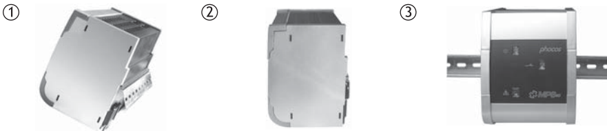
Abb. 1, 2 und 3 veranschaulicht, wie die MPS Einheit auf einer 35 mm DIN Hutschiene montiert wird. Befestigen Sie die DIN Hutschiene auf einer senkrechten Oberfläche.
